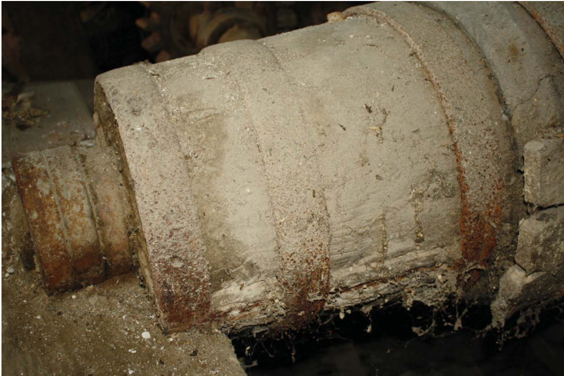
Obr.č.11. dubová hriadeľ, osadenie v ložisku - puzdre - stav pred reštaurovaním.
